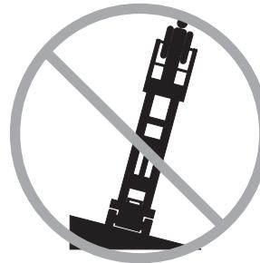
Nu contați pe alarma de înclinare ca indicator de nivel. Alarma de înclinare este emisă la nivelul şasiului și al platformei când utilajul este amplasat pe o pantă.
