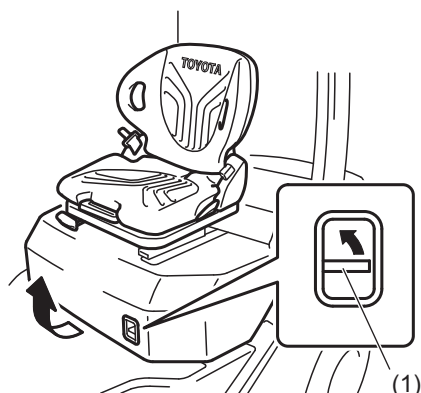
(1) Maneta de eliberare a dispozitivului de blocare a capotei motorului
